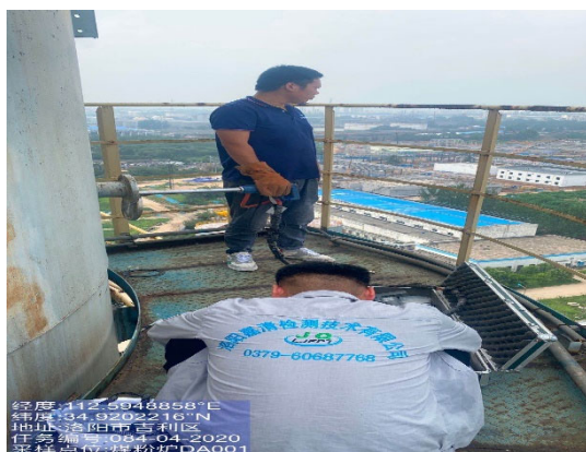
采样口及采样平台照片
