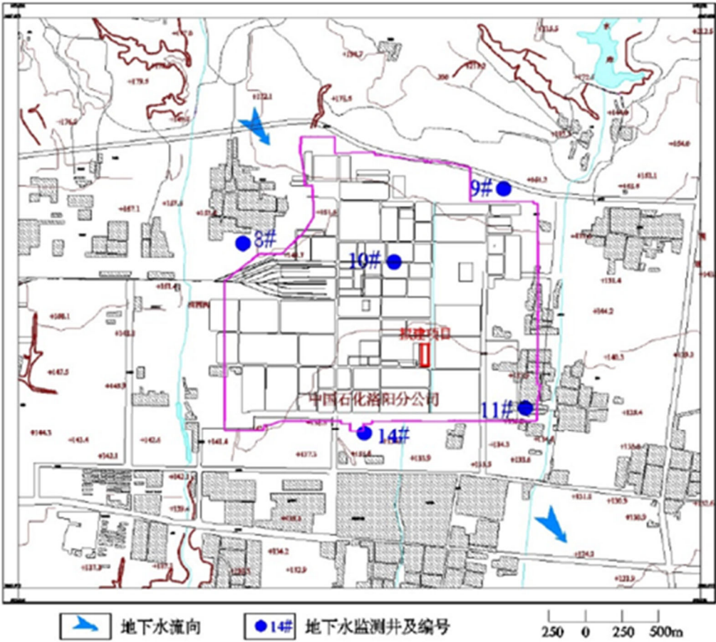
图 3.4-1 本项目地下水监控井分布图
